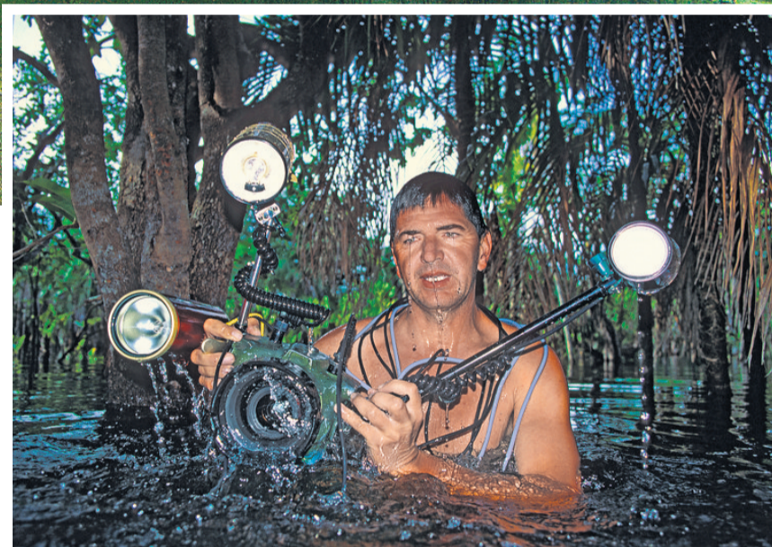
Michel Roggo utilise un prototype de boîtier étanche muni d'un déclencheur à distance.
