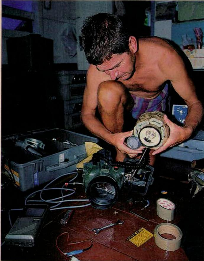
Im feuchtheissen Klima versagten die elektronischen Geräte regelmässig. Reparaturen auf dem Schiffsboden waren Routine.
